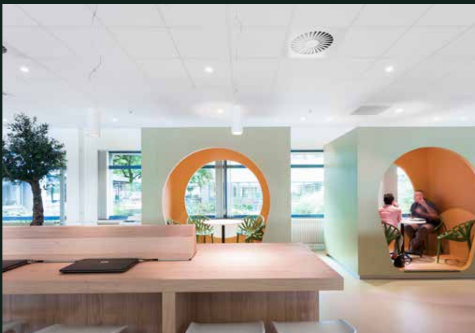
FOCUS A Synligt skinesystem og let demonterbare plader. Fås i mange formater.
