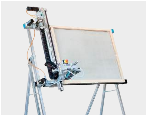
Skæring med skærerobot
